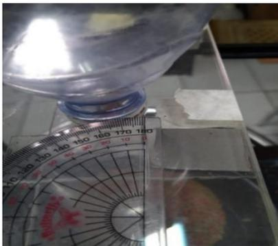
Gambar 7. Penentuan Derajat Buka Tutup Motor Servo
