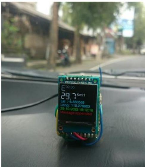
Gambar 10. Pengujian sistem waktu nyata
